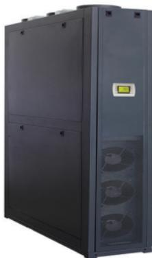
Межрядный автономный кондиционер предназначен для установки в ряду шкафов для подачи холодного воздуха в пространство изолированного коридора. Кондиционер выполнен в формате моноблока шириной 600 мм. На передней панели кондиционера расположена панель управления и отображения информации о температуре и режиме работы.
