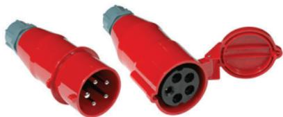
Трехфазная вилка и розетка IEC309 предназначены для установки на электрический кабель. Разборный корпус позволяет удобно провести монтаж изделия на кабель. Разъем фиксируется на кабеле при помощи цангового зажима, обеспечивающего надежное крепление и герметичность корпуса.
