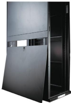
Съемные боковые панели с замками для шкафов LANMASTER серии DCS поставляются в виде отдельной позиции. Объединение шкафов в ряд возможно как с установленными панелями, так и без них. В комплект поставки входит 4 панели, по 2 шт. на каждую сторону шкафа.
