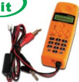
Тестовая телефонная трубка предназначена для тестирования аналоговых телефонных линий.
