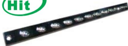
Шина заземления предназначена для организации точек подключения к заземлению оборудования и деталей шкафа. Шина монтируется на монтажные профили шкафа при помощи гаек и болтов М6.
