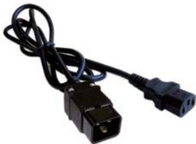
Шнур электрический силовой предназначен для подключения электрооборудования к сети переменного тока до 250В. Шнур изготовлен из многожильного провода ПВС, сечением 3x0.75 мм. Вилки и оболочка шнура изготовлены из не поддерживающего горения ПВХ.
