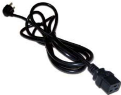
Шнур электрический силовой предназначен для подключения электрооборудования к сети переменного тока до 250В. Шнур изготовлен из многожильного провода ПВС, сечением 3x1.5 мм. Вилки и оболочка шнура изготовлены из не поддерживающего горения ПВХ.
