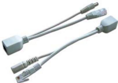
Комплект пассивных адаптеров POE предназначен для передачи сигнала питания к активному оборудованию по парам 4/5 (+) и 7/8 (-). Комплект состоит из двух адаптеров: инжектора (PSE), устанавливаемого после активного оборудования, и сплиттера (PD), устанавливаемого перед подключаемым устройством. Адаптеры имеют разъем 2.1 мм, совместимый с большинством имеющихся на рынке блоков питания.
