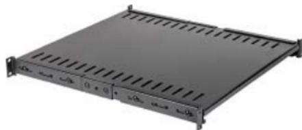
Раздвижная полка предназначена для установки в стойку с регулируемой глубиной. Глубина полки изменяется в диапазоне 560–1020 мм и фиксируется при помощи боковых винтов. Полка имеет крепление на 4 монтажных профиля, с фронтальной фиксацией.
