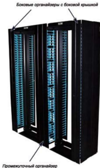
Распределительная телекоммуникационная рама, используется для открытого размещения сетевого и телекоммуникационного 19" оборудования. Секции рамы могут объединяться в ряд при помощи промежуточных органайзеров. По краям рамы могут быть установлены боковые органайзеры с боковой панелью.
