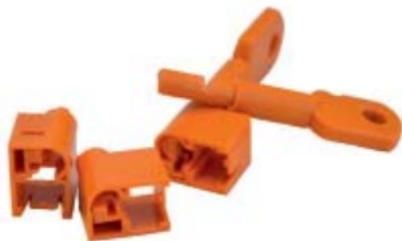
Блокиратор коннектора RJ-45 предназначен для фиксации коннекторов RJ-45 в портах коммутационного оборудования, путем блокирования возможности нажатия на язычок коннектора. Этим исключаются возможность преднамеренного или случайного извлечения коммутационного шнура из порта коммутационной панели или оборудования. Установка и снятие блокираторов коннектора RJ-45 осуществляется при помощи специального ключа, который идет в комплекте поставки.
