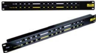
Панель POE (Power Over Ethernet) предназначена для передачи сигнала питания к активному оборудованию с функцией поддержки POE, либо к пассивным адаптерам POE (PD) по парам 4/5 (+) и 7/8 (-). POE панель является инжектором (PSE) и должна быть установлена между активным оборудованием и патч-панелью с горизонтальными кабелями. Коммутация осуществляется с помощью стандартных патч-кордов RJ-45.
