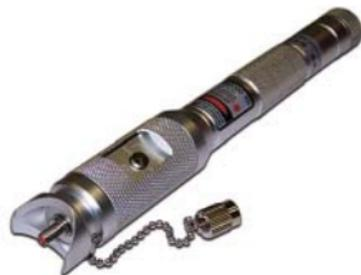
Визуальный дефектоскоп используется для контроля повреждений и дефектов в оптическом волокне. Для поиска дефектов используется сверхяркое излучение в видимом спектре (650 нм – красный цвет). Прибор имеет универсальный разъем 2,5 мм. В процессе проверки места дефектов и повреждений светятся ярким красным светом. Режим мерцания обеспечивает видимость красного сигнала даже при ярком окружающем свете.
