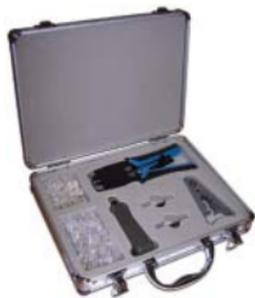
Набор инструмента предназначен для изготовления телефонных и компьютерных соединительных шнуров, а также монтажа кабеля типа витая пара на патч-панелях, розетках и кроссах. Инструменты, входящие в набор, позволяют производить операции по обрезке и зачистке кабелей, разделке кабеля на IDC-разъемах, а также обжиму коннекторов RJ-12 и RJ-45. Для удобства хранения и транспортировки инструменты поставляются в алюминиевом кейсе с укладочной формой.
